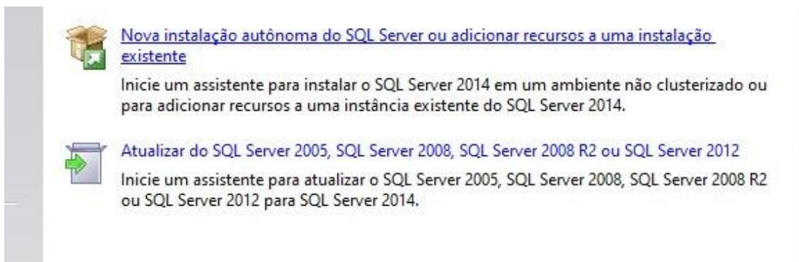
Clique em Nova Instalação autônoma do SQL Server para fazer as configurações necessárias para a instalação do arquivo
